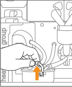
1) Gerät ausschalten, Auslaufschlauch des Brühers aus der Halterung 13 nach oben abziehen.
