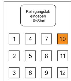
6) Nach 2 kurzen Spülzyklen werden Sie aufgefordert das Reinigungsmittel in den Brüher einzugeben. Bild 7
