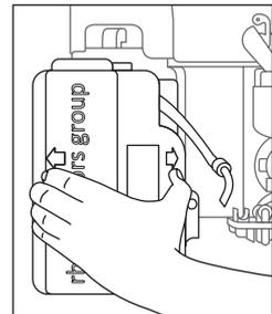
9) Die Abdeckung 36 des Brühers wieder anbringen, Schlauch durchführen und in Halterung 13 einstecken.
