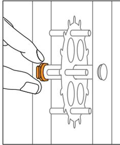
5) **Innen:** Die 2 grauen Halteclips (links und rechts) entnehmen, nach oben abziehen.
