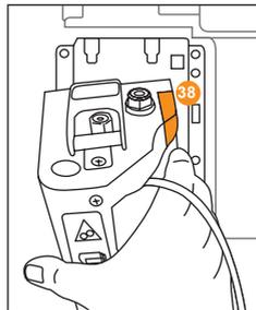
8) Der orange Entsperrhebel 38 muss ganz einrasten, sonst wird eine Störung angezeigt.
