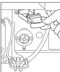
8) Nach Demontage der Mischschale und Produktrutschen den Absaugkanal entnehmen und reinigen.
