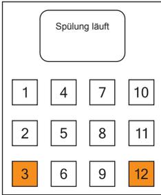
1) Drücken Sie bei geschlossener Gerätetüre gleichzeitig die **Taste 3 und 12** auf der Wahl tastatur.
