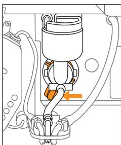
4) Bajonetverschluss der Mischschale **14** (oranger Hebel) unten nach links drehen.
