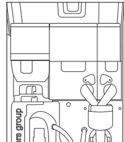
6) Erweitern Sie die Reinigung: Gerätetüre und Deckel öffnen. Überprüfen Sie den Füllstand der Produkte, füllen Sie ggf. nach.
