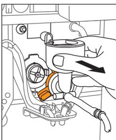
5) Die Mischschale nach vorne abziehen und Schlauch aus der Halterung drücken. Entnehmen Sie den Dampfring von der Mischschale.
