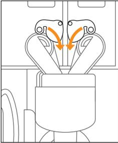
1) **Instantprodukte:** Die Verschlussriegel vor dem Befüllen druch drehen nach unten schließen.
