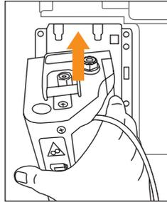
5) Durch leichtes Anheben können Sie den Brüher aus der Motorhalterung abziehen.
