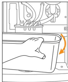
8) Entnehmen und entleeren Sie den Kaffeesatzbehälter **12**. Reinigen Sie den Geräteboden innen. Setzen Sie die Teile wieder ein.
