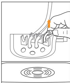
1) Öffnen Sie die Türe, das Gerät ist aus. Entnehmen Sie die Auslaufschläuche aus der Auslaufhalterung, **13** indem Sie diese nach oben abziehen.
