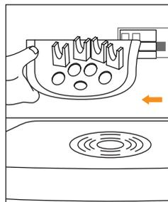
3) Schieben Sie die Auslaufhalterung auf die linke Seite, während Sie den Kunststoff-Steg drücken. Reinigung mit Reiniger und heißem Wasser.
