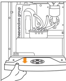
7) Entnehmen und entleeren Sie die Tropfschale **14**, reinigen Sie das Tropfgitter **25** von innen und außen.
