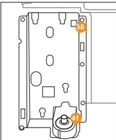
7) Den Brüher auf den Antrieb 41 aufsetzen, nach unten drücken und den Entsperrhebel 38 einrasten.
