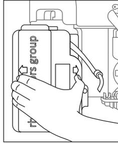
2) Die Abdeckung 36 an den Pfeilen seitlich drücken, abziehen und Schlauch herausziehen.
