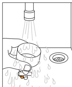
6) Warmes Wasser und Reiniger lösen die Produkt-rückstände zuverlässig. Keine rauen Reinigungsschwämme verwenden.
