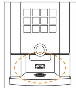
9) Reinigen Sie den Ausgabebereich **24** sowie den Tassentisch **26**. Schließen Sie das Gerät. Das Gerät ist wieder betriebsbereit.
