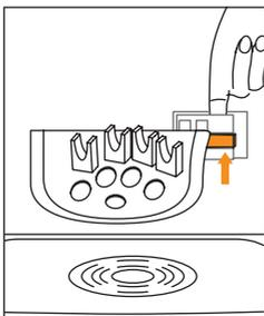
2) Entnehmen Sie die Auslaufhalterung, indem Sie rechts den mittleren Kunststoff-Steg von hinten aus der Metallhalterung drücken.
