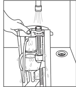
6) Den Brüher mit warmem Wasser und BIO Reiniger spülen. Trocknen Sie danach den Trichter gut ab.
