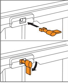
1) Türkontaktschlüssel einstecken und durch 90° Drehung nach unten das Gerät einschalten. Warten bis das Gerät betriebsbereit ist.
