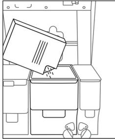
2) Deckel der Instantproduktbehälter öffnen und Produkte nach Etikettierung einfüllen.
