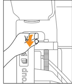
3) Entnehmen Sie den Auslauf 18 am Mahlwerk durch einfaches Abziehen.
