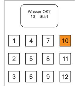
3) Sicherheitsabfrage 2: Ist die Wasserzufuhr geöffnet? Wenn ja, **Taste 10** drücken.
