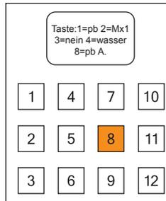
5) Auswahl des Reinigungsprogramm für Brüher = **Taste 8** drücken. Die Spülung wird dann aktiviert.
