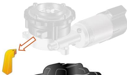
Entfernen Sie das orangefarbene Förderband des gemahlten Produkts, indem Sie es einfach herausziehen.
