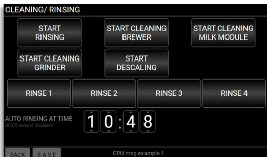
drücken Sie auf "REINIGEN/SPÜLEN", um den Reinigungszyklus des Wasserkreislaufs (Heizung, Schläuche, Mixerschalen) zu aktivieren. Drücken Sie nacheinander die Tasten "SPÜLEN 1 2 3", um den Reinigungszyklus des entsprechenden Hydraulikkreises (Mixerschalen) zu aktivieren. Drücken Sie die Taste "SPÜLEN 4", um den Reinigungszyklus mit direktem Heißwasser zu aktivieren.
