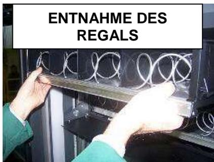
SICHERSTELLEN, DASS DIE KASSETTE VOLLSTÄNDIG ZURÜCKGESCHOBEN IST
